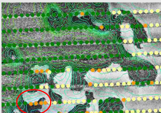
Données complémentaires SACLAF (de classification acoustique) En jaune : Sédiment sableux - En orange : Substrat grossier En vert : Substrat de hauteur supérieure à 10 cm
