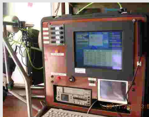
Système MOBIDIC HD (Module d'Observation des Biocénoses par Imagerie Digitalisée pour le Côtier à Haute Définition), mis au point par l'IFREMER : Châssis support de caméra & Régie surface @Ifremer
